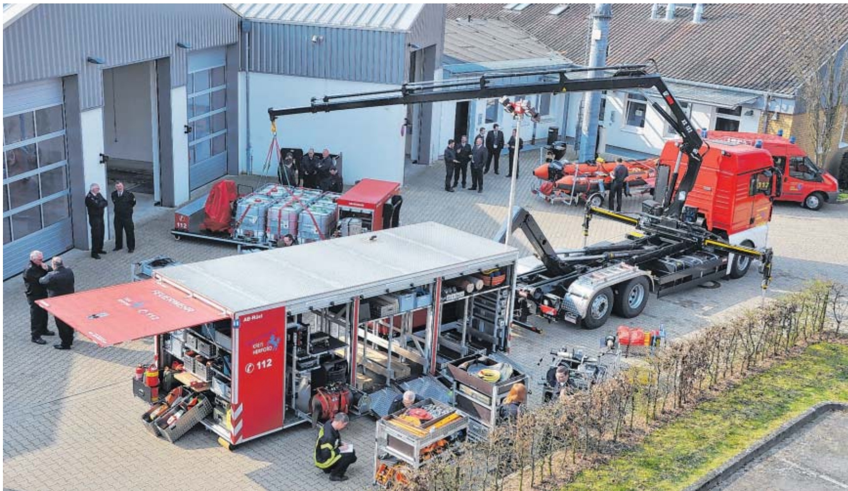
Die Kreisfeuerwehrentrale von hinten: Zu sehen ist ein Transportfahrzeug, das kann Behälter und Container tragen. Das modulare System kann für jeden Einsatz individuell angepasst werden.
